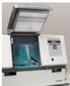
Urządzenie do badania odporności na promieniowanie UV - SUNTEST
